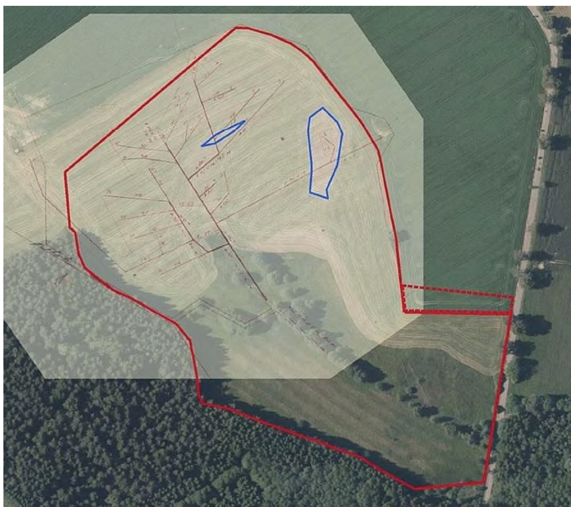
Obr. 2 Georeferencovaná situace drenážního odvodnění z původní projektové dokumentace stavby z roku 1969, se zákresem míst detekovaných poruch drenážního systému (modrá barva), zaměřených v terénu v roce 2013.
