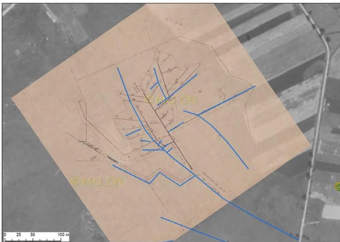
Obr. 3 Zákres povrchových příkopů identifikovaných na archivním leteckém měřickém snímku z roku 1938 (modré linie) na pozadí situace projektové dokumentace podpovrchového drenážního odvodnění z roku 1969.
